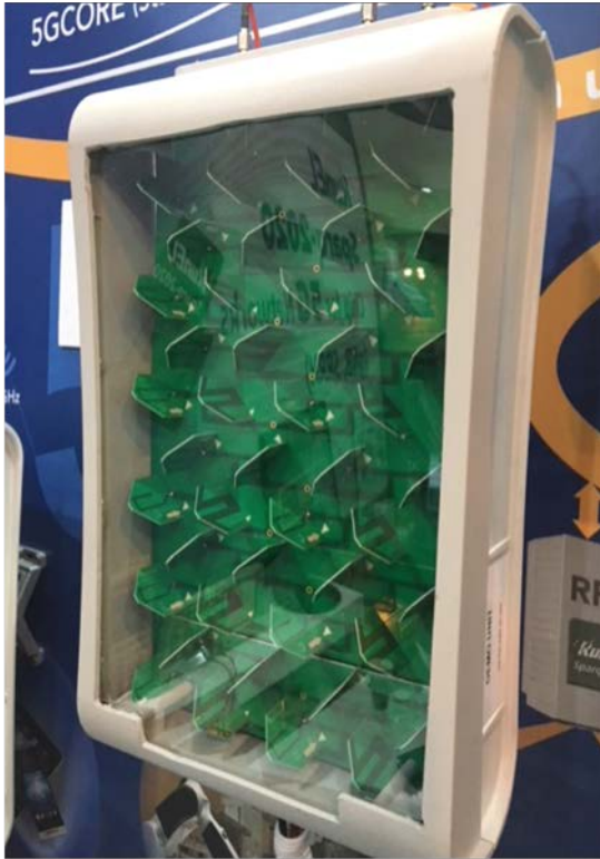
図 4：5G 対応の基地局（1パネルに44の交差偏波アンテナ）
